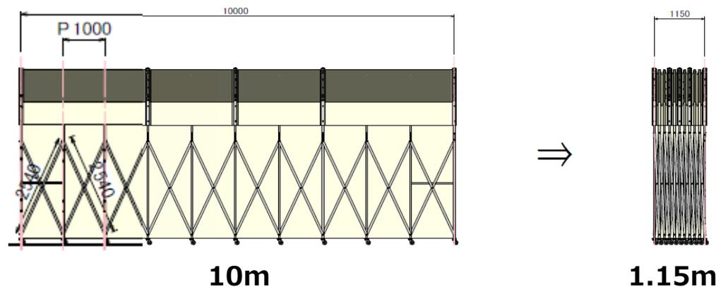
桁方向は約1m間隔で用途、敷地に合わせて延長可能。
